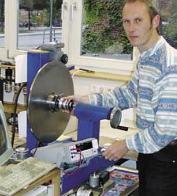
Kompetenz in Sachen Beleuchtung: aktiv Radfahren-Lichtexperte Andreas Oehler beim Test der Nabendynamos bei Schmidt Maschinenbau in Tübingen
